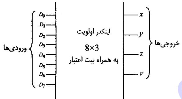
در جدول فوق اولویت ورودی  $D_7$  از بقیه ورودی‌ها بیشتر است و به طور کلی ترتیب اولویت‌ها به صورت  $D_0 < D_1 < D_2 < D_3 < D_4 < D_5 < D_6 < D_7$  می‌باشد بنابراین مثلاً در خط آخر که  $D_7 = 1$  است مقدار بقیه ورودی‌ها اهمیت نداشته و خروجی برابر  $x = y = z = 111$  خواهد بود. بیت  $V$  (بیت اعتبار) هنگامی که هیچ یک از ورودی‌ها فعال نباشد (هیچگدام از  $D$  ها برابر 1 نباشد) برابر 0 خواهد بود و لذا در لحظه‌ای که  $V = 0$  است مقدار خروجی‌ها  $(x, y, z)$  نا معتبر بوده و نباید استفاده شوند.
