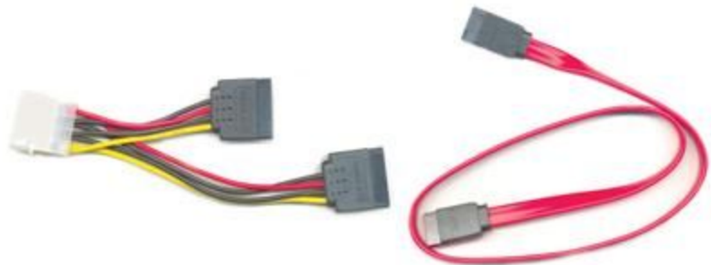
شکل ۳: نمونه ای از کابل دیتای SATA و کابل Y-adaptor
